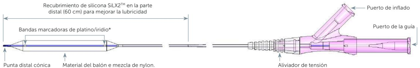
\*Hay dos bandas marcadoras que indican los extremos de la superficie de trabajo en todos los tamaños excepto en el de 1,25 mm por 15 mm y 1,5 mm por 15 mm, donde una sola banda marcadora está centrada en la superficie de trabajo.
